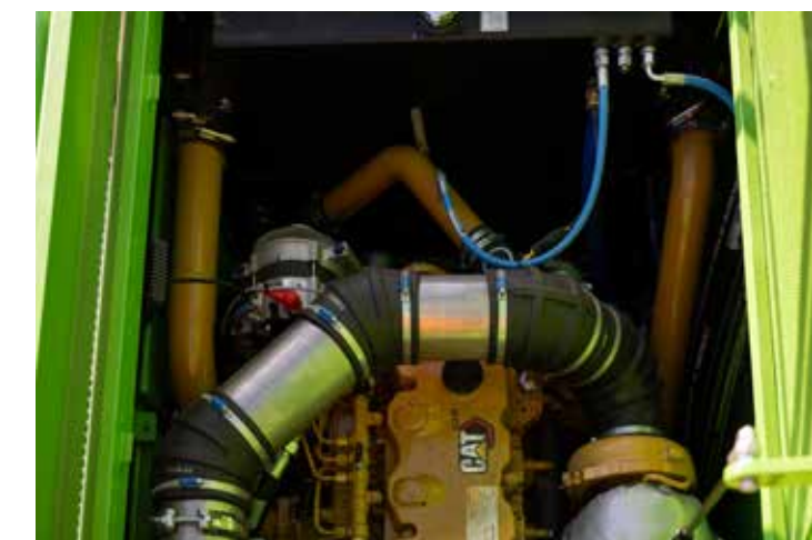
De 350 pk sterke Caterpillar C13 krachtbron voldoet aan de strengste emissienorm.
