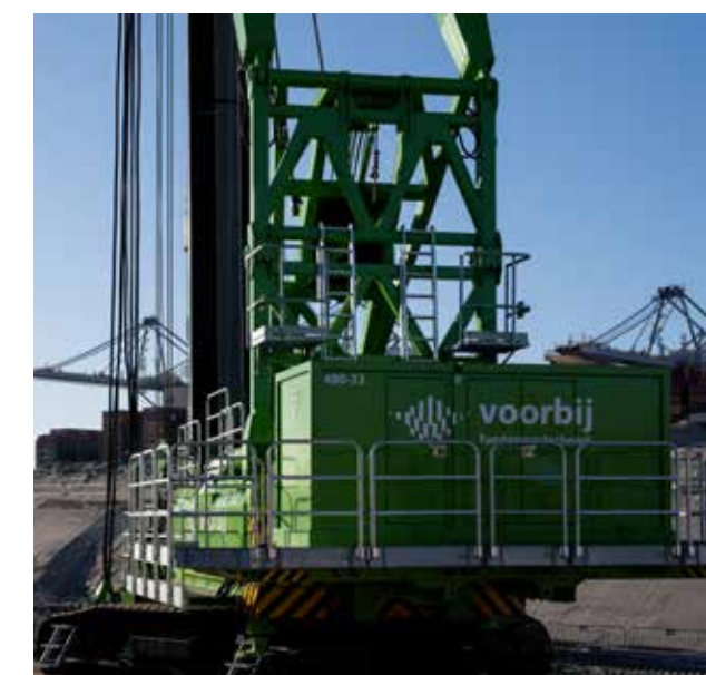
Voorbij draagt veiligheid en duurzaamheid hoog in het vaandel. De Woltman 160 DR is daarom voorzien van Stage V motoren (ook voor de PVE powerpack achterop) en vele bordessen, trappen en relingen.
