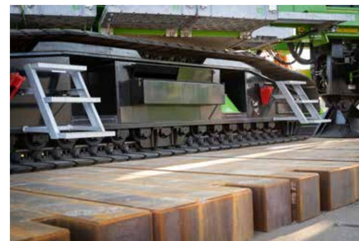
Woltman funderingsmachines staan bekend als robuust en betrouwbaar. Voor optimale stabiliteit is de Beco onderwagen verbreedbaar tot max. 5,3 meter.
