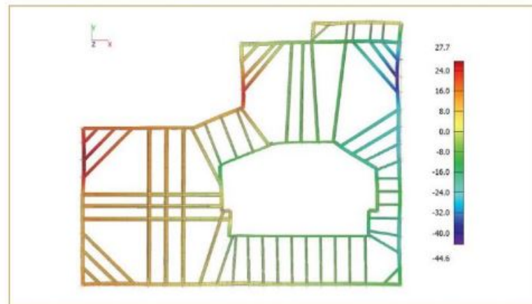
Figuur 3 - Berekende vervorming stempelraam.
